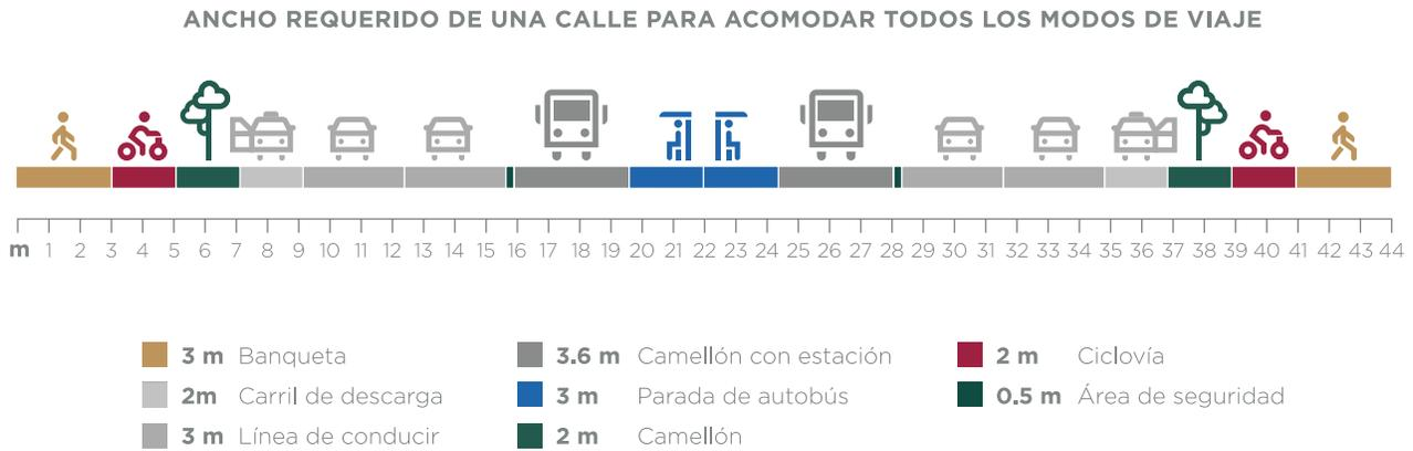
Figura 40. Ancho requerido de una calle para acomodar todos los modos de viaje
